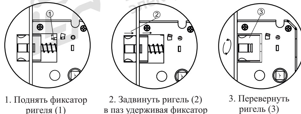
Рисунок №2.4 – Изменение направления открывания замка
